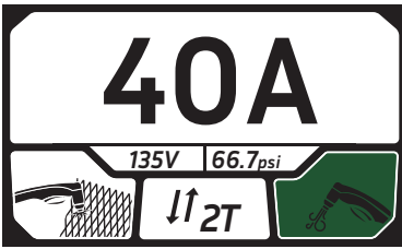
Purga de gas desactivada
